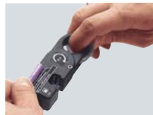
Medir la longitud de cable alineándolo con la plantilla de medida. Marcar el tope con el dedo índice de la mano izquierda.
