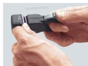
Sujetar el extremo del cable en la FCS hasta el tope.
