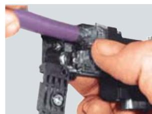
Introducir los hilos en el conector de acuerdo a sus marcas de color, apretar el inmovilizador y atornillar el alivio de tracción.
